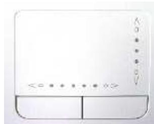
Touchpad se sastoji od lijeve i desne tipke koje odgovaraju tipkama na mišu, pravokutnog polja i (ovisno o podešenju) dva ruba koji odgovaraju kotačiću miša jer služe za vertikalni i horizontalni scroll. Kažiprstom ili palcem klizimo po pravokutnom polju, a pointer (ili kurzor) se po ekranu kreće u istom smjeru. Na rubu touchpada možemo prst podići, vratiti ga prema sredini i nastaviti s radom.
