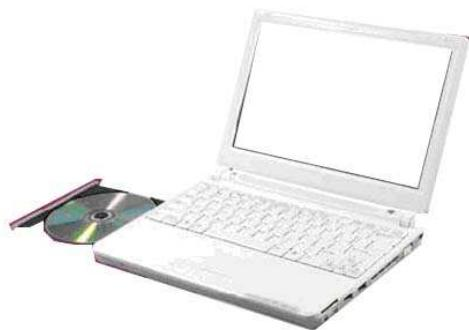
Kad stavljate CD ili DVD medij u uređaj, pazite na pravilnu orientaciju: naljepnica odnosno naslovnica mora biti s gornje strane. Medij ne smije biti oštećen, jer time može oštetiti i uređaj. Medij namjestite na osovinu pogona i lagano pritisnite na mjesto. Ne primjenjujte silu.
