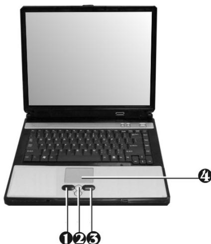
Touchpad se sastoji od lijeve (1) i desne (3) tipke koje odgovaraju tipkama na mišu, pravokutnog polja (4) i dvije tipke (2) koje odgovaraju kotačiću miša. Kažiprstom ili palcem klizimo po pravokutnom polju, a pointer (ili kurzor) se po ekranu kreće u istom smjeru. Na rubu touchpada možemo prst podići, vratiti ga prema sredini i nastaviti s radom.
